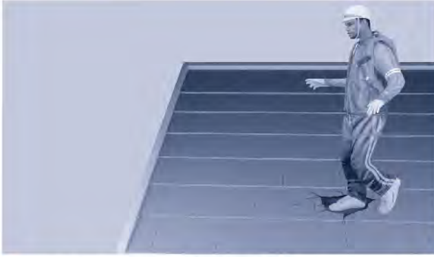
1. การเดินบนหลังคาควรเดินอย่างระมัดระวังหลีกเลี่ยงการเหยียบบริเวณลื่นรางด้านข้างของกระเบื้อง เพราะอาจทำให้กระเบื้องเกิดบิ่นแตกได้
